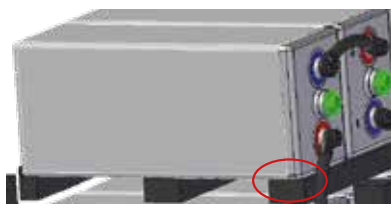
Nesprávne, slabé miesto leží na lište skrine, pozri zvýraznené označenie
