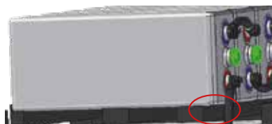
Správne, slabé miesto neleží na lište skrine, pozri zvýraznené označenie
