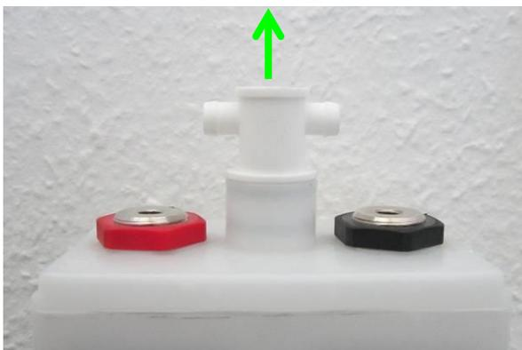
3. Einsetzen des neuen Wassernachfüllstopfens: Der Wassernachfüllstopfen muss gerade in die Zelle eingeführt werden. Er muss sich durch leichten Druck mit dem Handballen einschieben lassen. Keinesfalls darf der Stopfen mit Werkzeugen (Hammer o.Ä.) hineingeschlagen werden.
