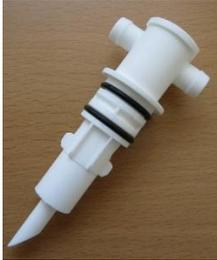
Die verwendeten Stopfen zum Nachfüllen von deionisiertem / destilliertem Wasser arbeiten ohne bewegliche Teile. Das Wasser wird mit einer konstanten Durchflussmenge in das Nachfüllsystem gepumpt und fließt nacheinander in die Zellen. Die Luft darin entweicht dabei durch ein Steigröhrchen. Sobald dieses bei Erreichen des maximalen Elektrolytstandes in den Elektrolyten eintaucht, kann keine weitere Luft entweichen und die weitere Zufuhr von Wasser wird unterbunden.
