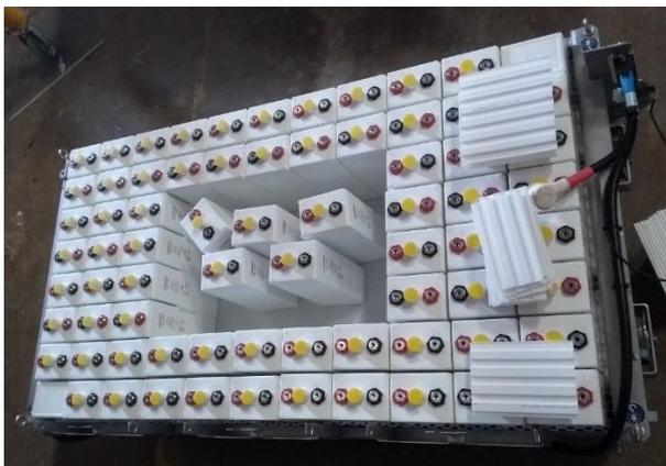
2. Montare i connettori delle celle seguendo il disegno tecnico. Usare rondelle a molla nuove. Montare prima i connettori nelle file di celle, quindi i connettori tra le file di celle in ordine inverso rispetto allo smontaggio, vedere le seguenti illustrazioni di esempio:
