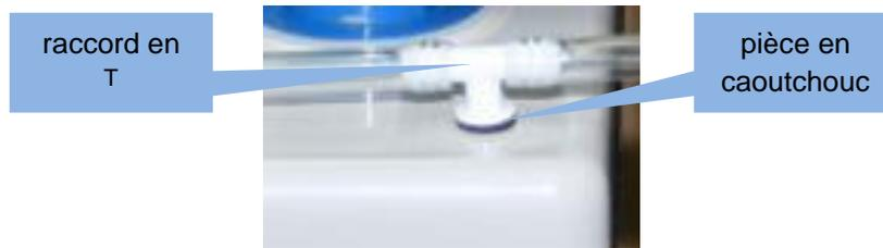
Fig. 8 : Raccord en T et pièce en caoutchouc
