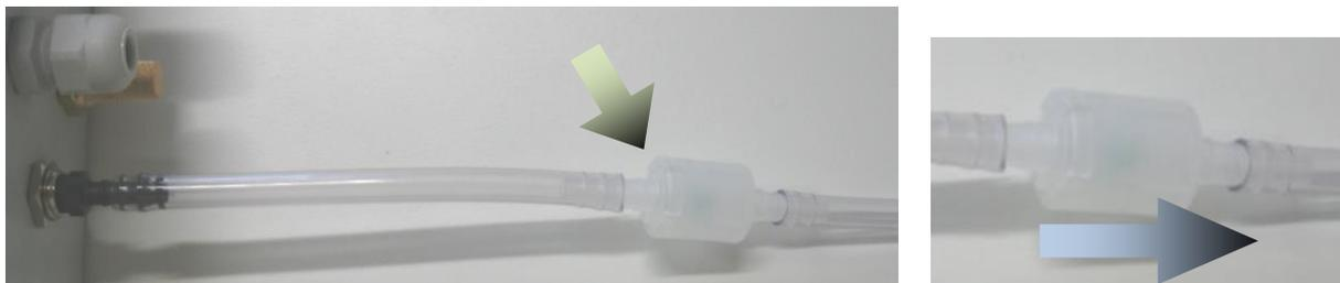
Fig. 14 : Branchement de la soupape de retenue
