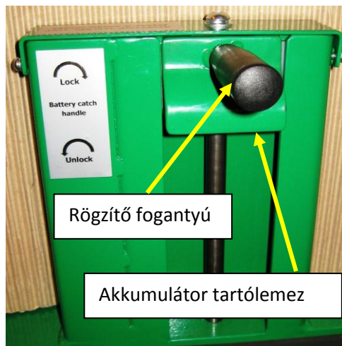
153. ábra: A PU-n lévő akkumulátoroszlop és akkumulátor-rögzítő kezdő pozícióban.
